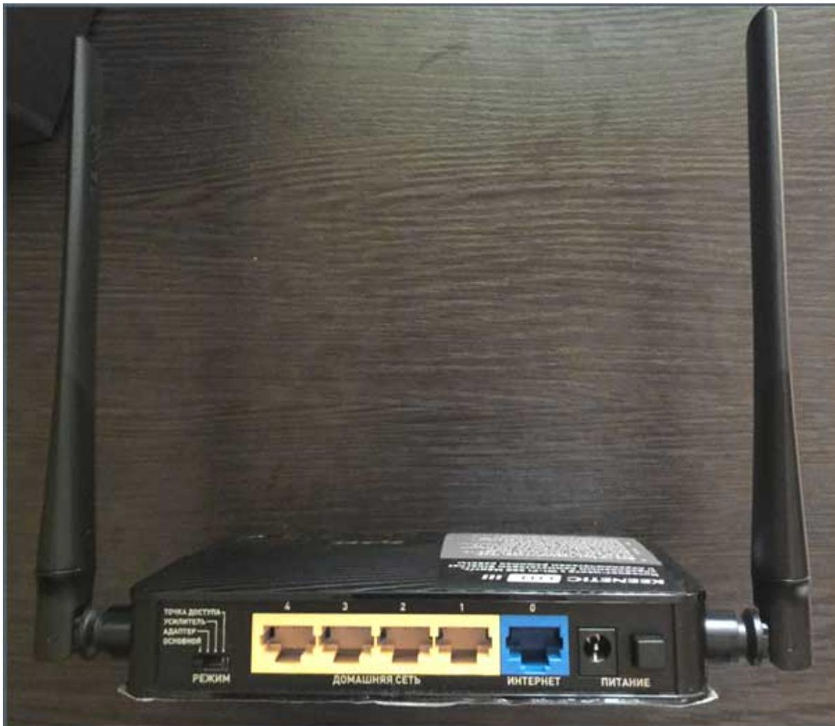
Во всех случаях, кабель Интернет-провайдера следует подключить к соответствующему порту «Интернет» на роутере, а переключатель режим установить в «Основной».
