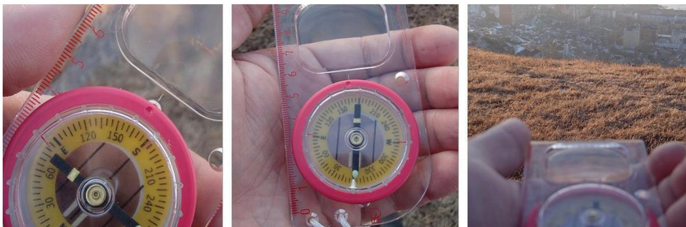
Поворачивая шкалу, устанавливаем указатель компаса на нужный угол: 168 градусов
