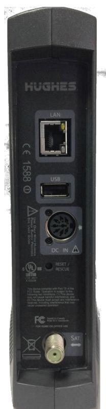
Разъём для подключения Ethernet порта компьютера
