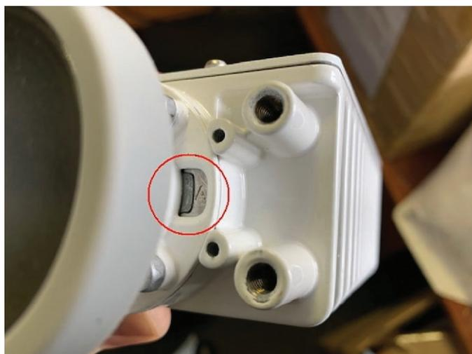
Рис.4. Положение поляризации «А»
