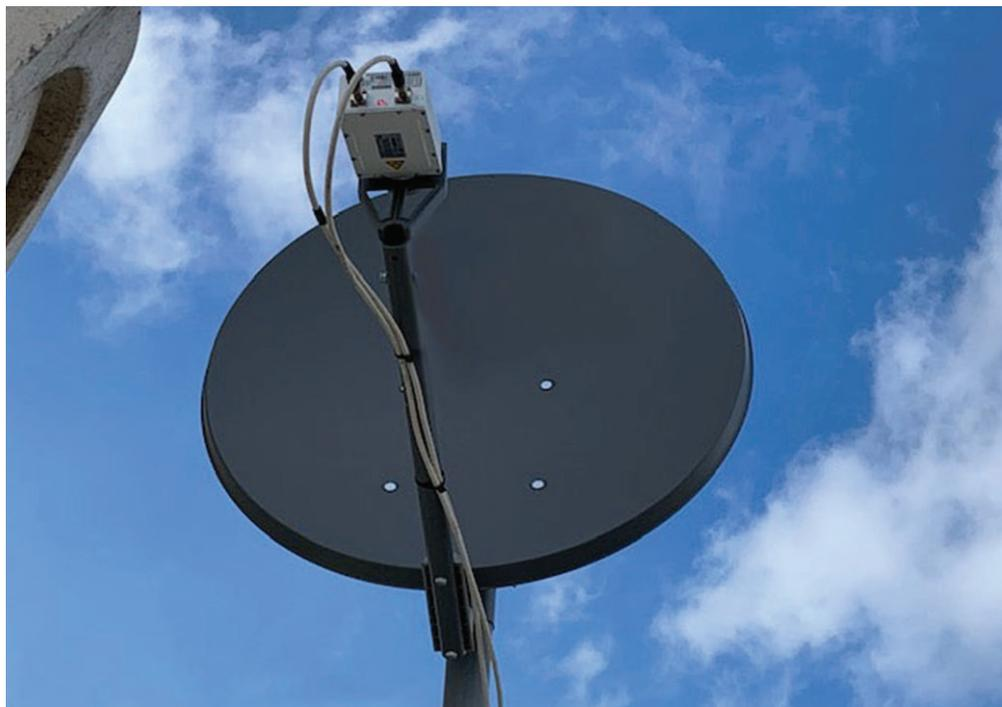
Рис.5. Антенная система в сборе с приемопередатчиком
