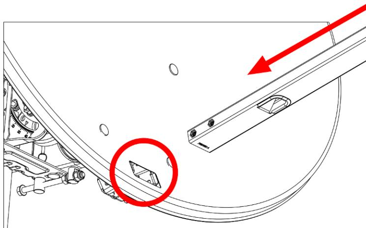
Рисунок 22: Вставка штанги облучателя в задний кронштейн
