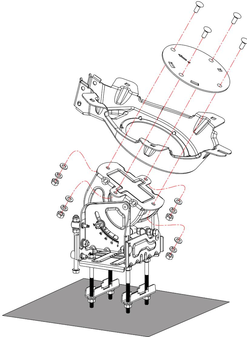
Рисунок 11: Сборка заднего кронштейна и опорно-юстировочного кронштейна
