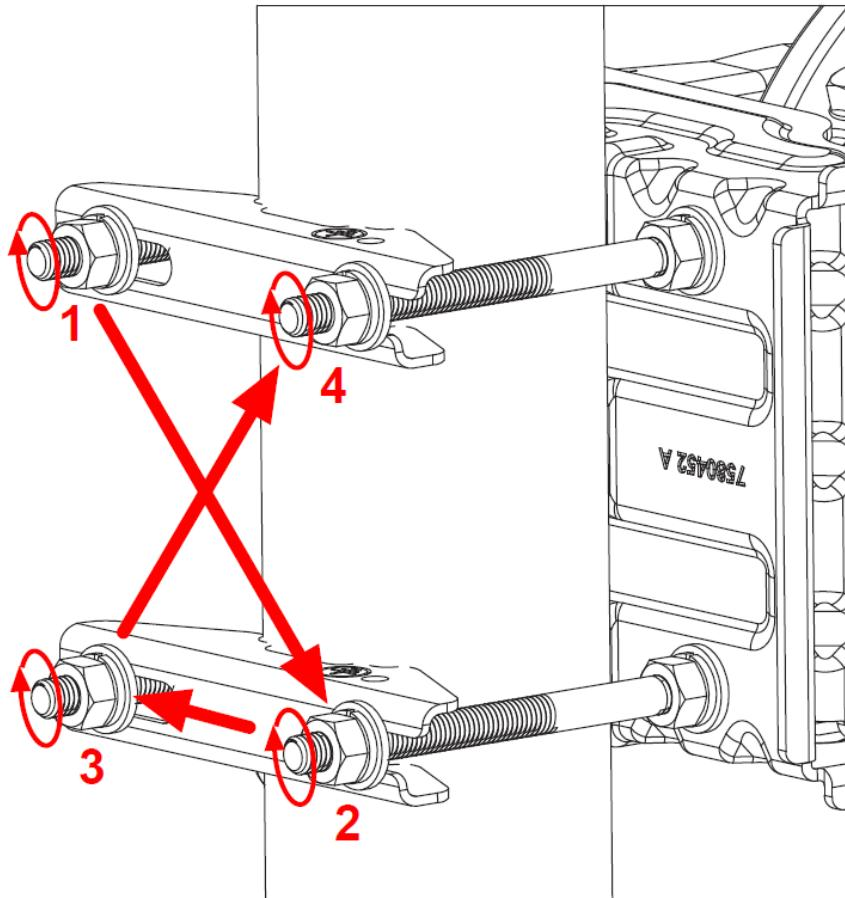
Рисунок 13: Затягивание гаек
