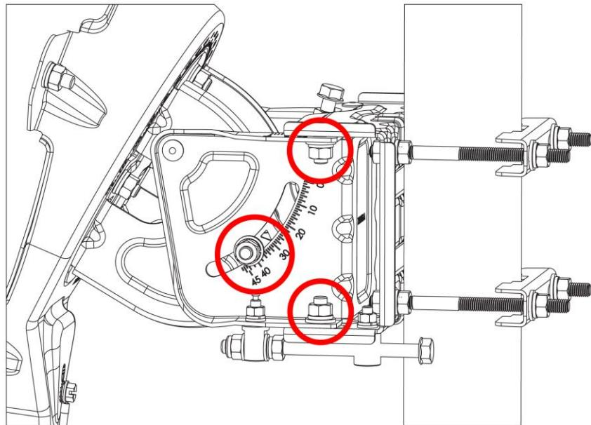
*Рисунок 50: Затягиваемые гайки*
