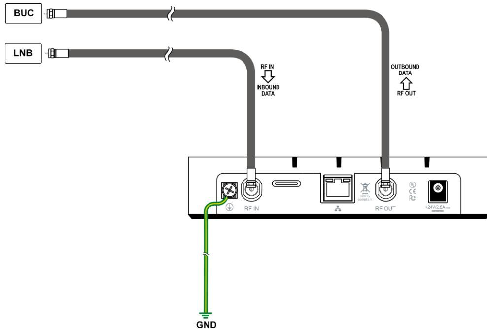
Рисунок 35: Радиочастотные соединения модема
