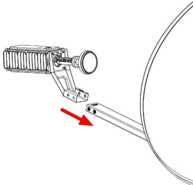
Рисунок 25: Сборка кронштейна приемопередатчика на штанге облучателя
