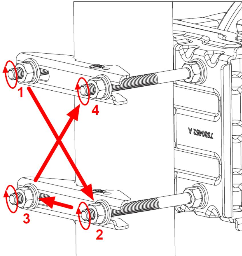
Рисунок 47: Затягивание гаек
