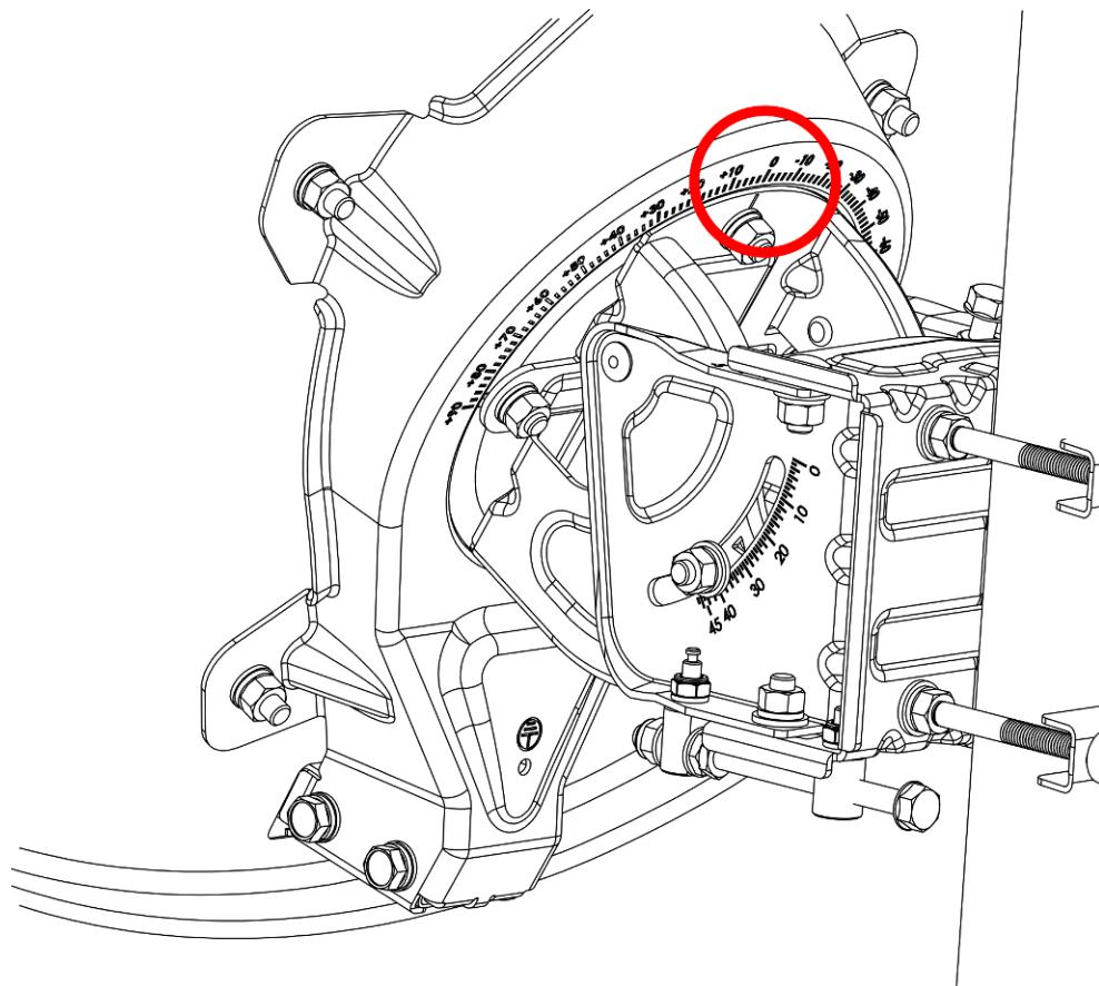
*Рисунок 29: Шкала наклона*
