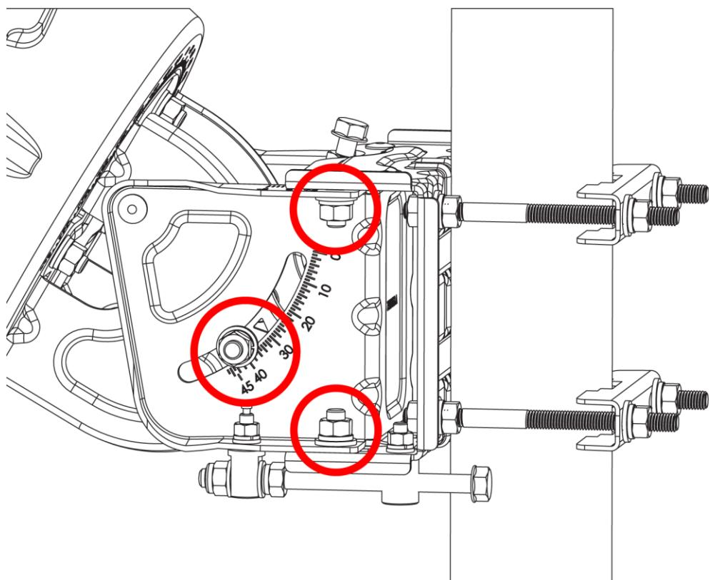
Рисунок 14: Крепежные гайки
