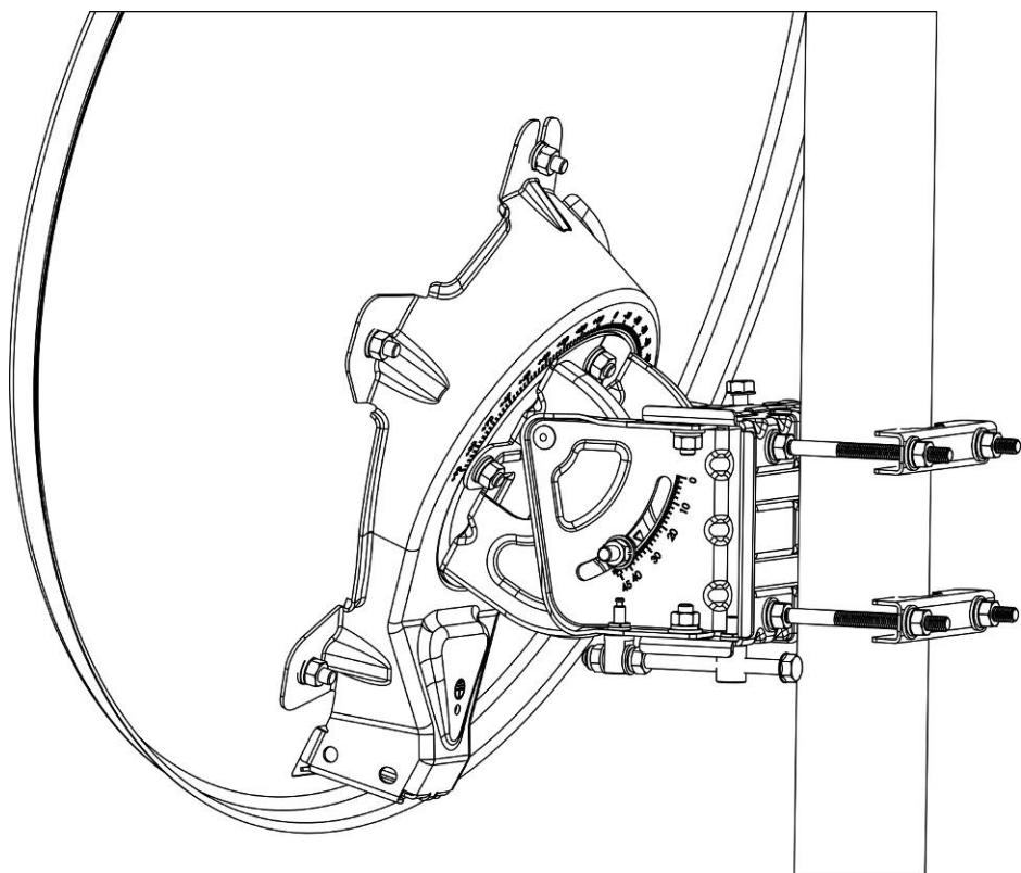
Рисунок 21: Отражатель, прикрепленный к заднему кронштейну
