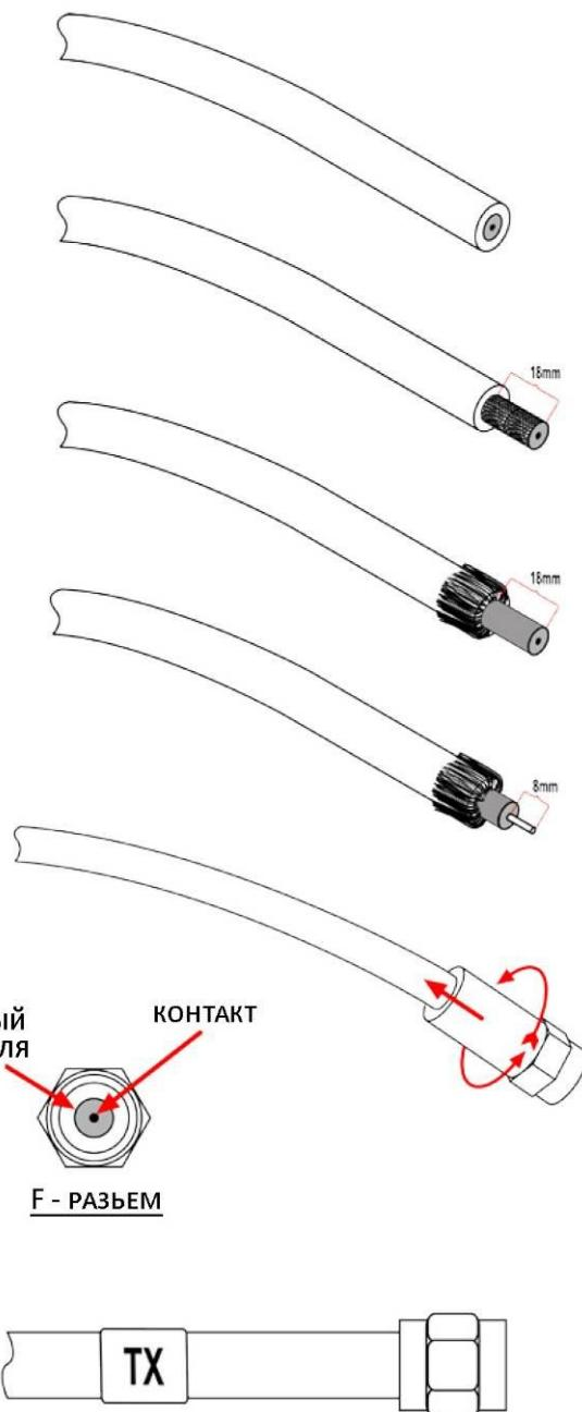
*Рисунок 33: Разъем, собранный на кабеле*
