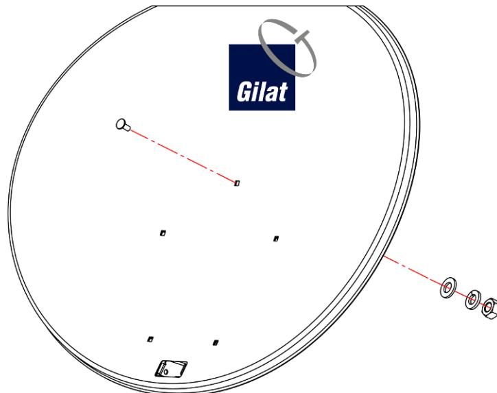
Рисунок 17: Отражатель - самое верхнее отверстие
