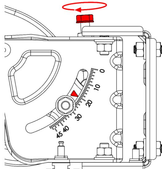
Рисунок 15: Винт регулировки угла места
