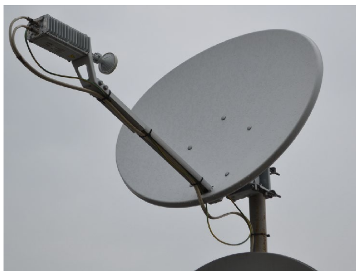
Рис.5. Антенная система в сборе с приемопередатчиком
